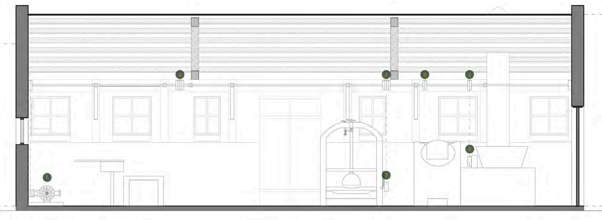
從昂坪茶園茶廠建築的剖面圖，可見整個三相電感應電動機傳動系統的運作原理：1. 動力先由發動機帶動牆身的金屬圓盤轉動；2. 金屬圓盤再把動力傳送至傳動系統其他四組圓盤；3. 圓盤再透過皮帶把動力傳送至工場不同的機械。圖像由香港中文大學研究團隊根據實地情況及舊照片繪製。
